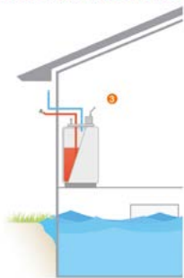
Variante 3 Aufstellung oberhalb des maximal möglichen Hochwasserstandes
