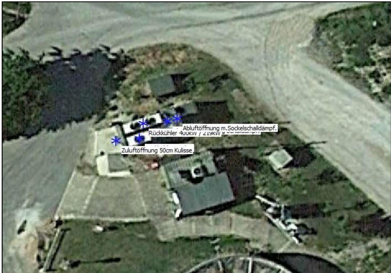
Vorangegangenes Luftbild zeigt die einzelnen Anlagenkomponenten als Schallquellen, die auf die Position des Containers, der Notkühler und Zu- und Abluftöffnungen, sowie des Schalldämpfers platziert wurden.
